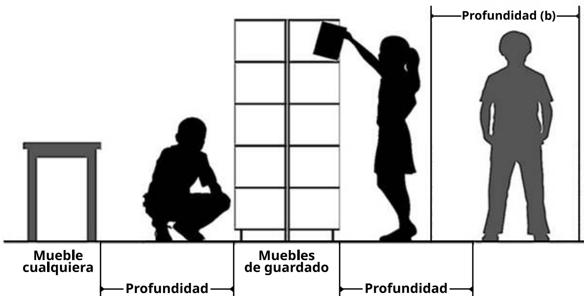
Ilustración 5 - Separaciones mínimas para muebles de guardado
