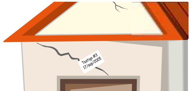
Muro con desplome No debe ser mayor a 1 cm
